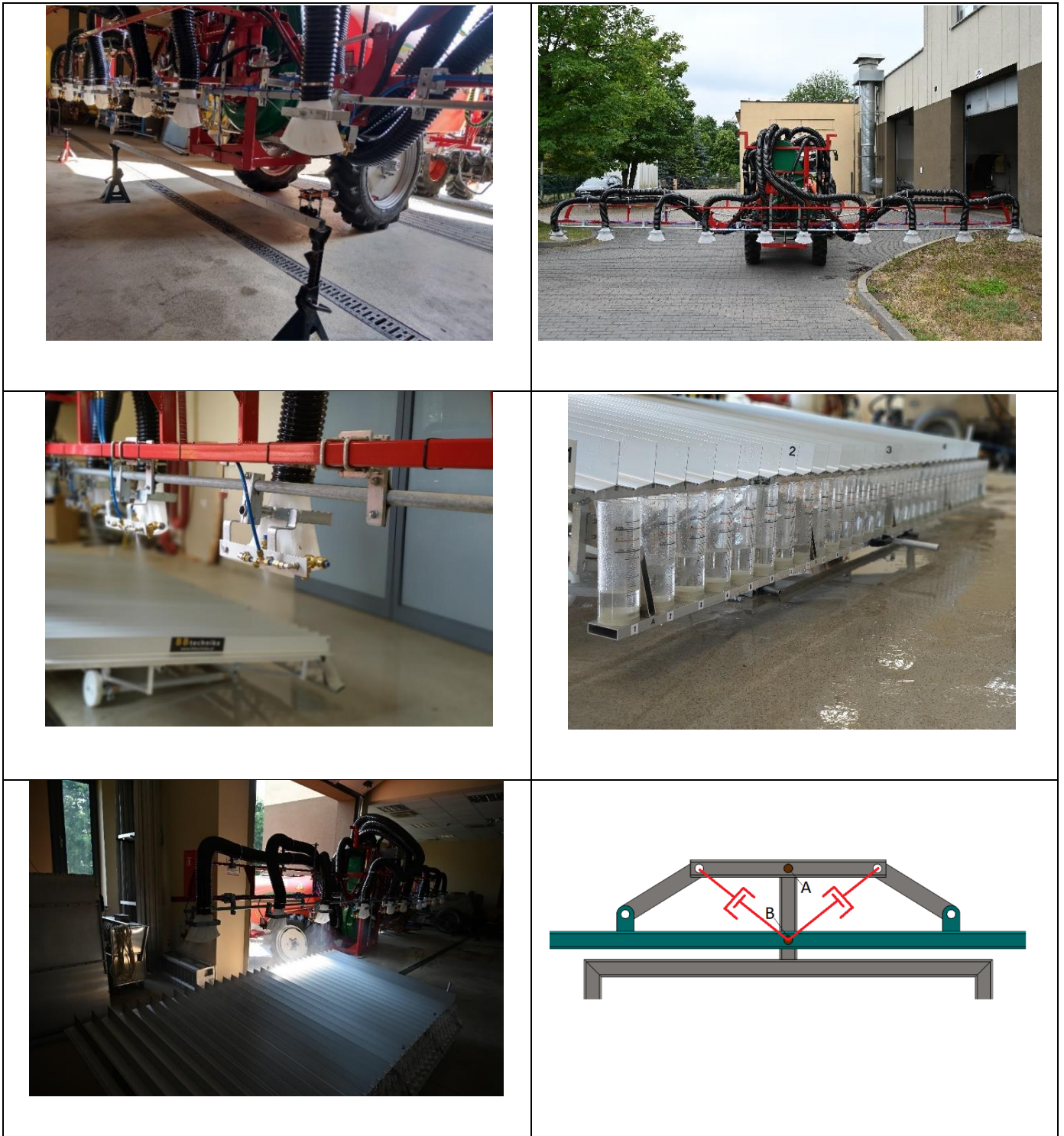
Rys. 3. Przykładowe rozwiązania i badania stanowiska badawczego w zakresie rozkładu poprzecznego cieczy i rozkładu prędkości strumienia powietrza oraz badania symulacyjnych wariantów wymuszeń wychyleń (drgań) belki opryskiwacza.
